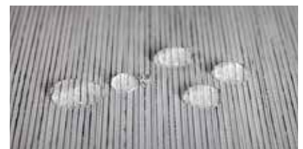
▲ Gewebe mit einer feuchtigkeitsabweisenden Teflon-Beschichtung eignen sich auch für Feuchträume wie Bad und Küche.
