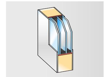
Sicherheitsfüllung RC2, verstärktes Aluminium, P4A-Sicherheitsglas, Füllung/Glas eingelebt
